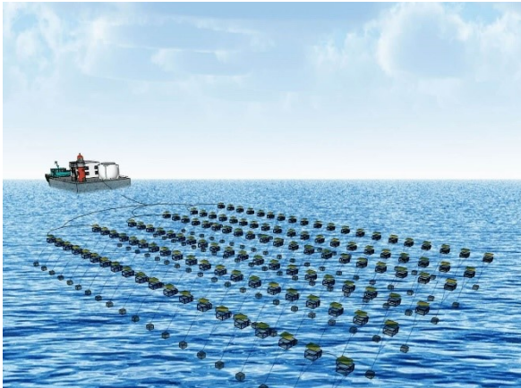
海流で水車を回し、発電機を駆動して電気をつくる
