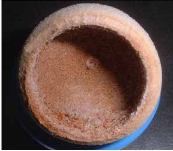
設置前 白色フィルター着色状況 (平成 19 年 11 月 9 日～11 月 19 日の 10 日間使用)
